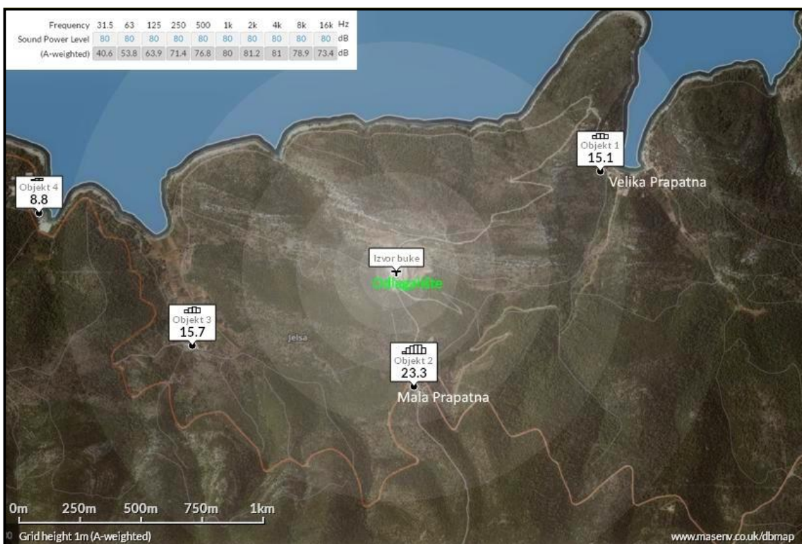
Slika 33 Modelske vrijednosti (jednostavni model bez uključenih zvučnih barijera i orografskih značajki) očekivanih ocjenskih imisijskih razina buke oko radilišta na sanaciji odlagališta Prapatna. Odbnosi se na potencijalnu buku koja potječe sa odlagališta. (Izvor: MAS Environmental Interactive Sound Level Calculator - www.masenv.co.uk/noisecalculator2 ).
