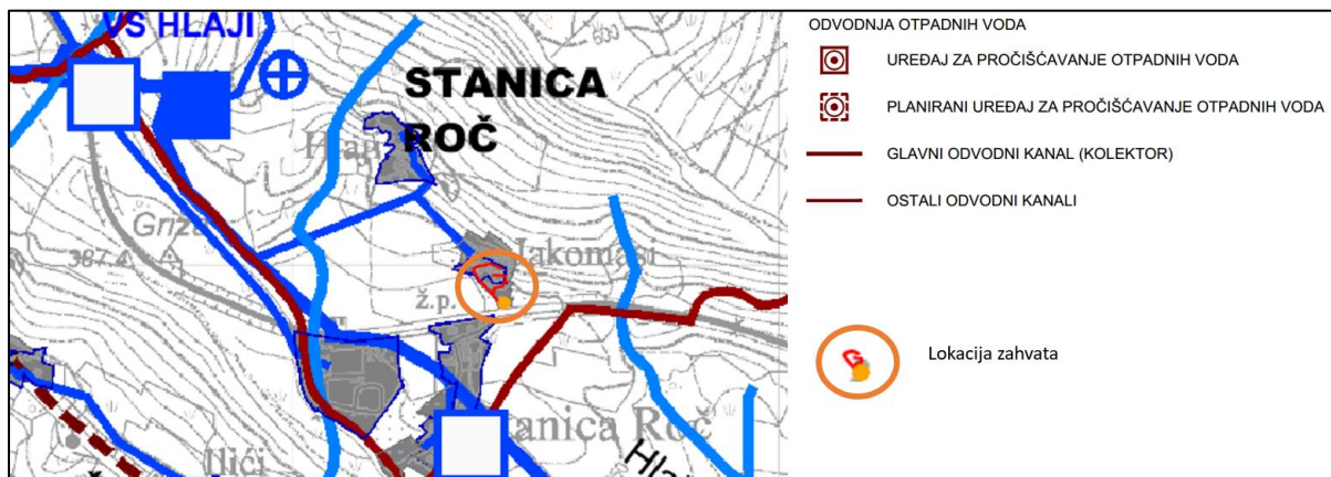
Slika 9. Odvodnja otpadnih voda, PPUG Buzet (izvadak: Infrastrukturni sustavi - Vodnogospodarski sustav, Broj kartografskog prikaza 2.2.)
