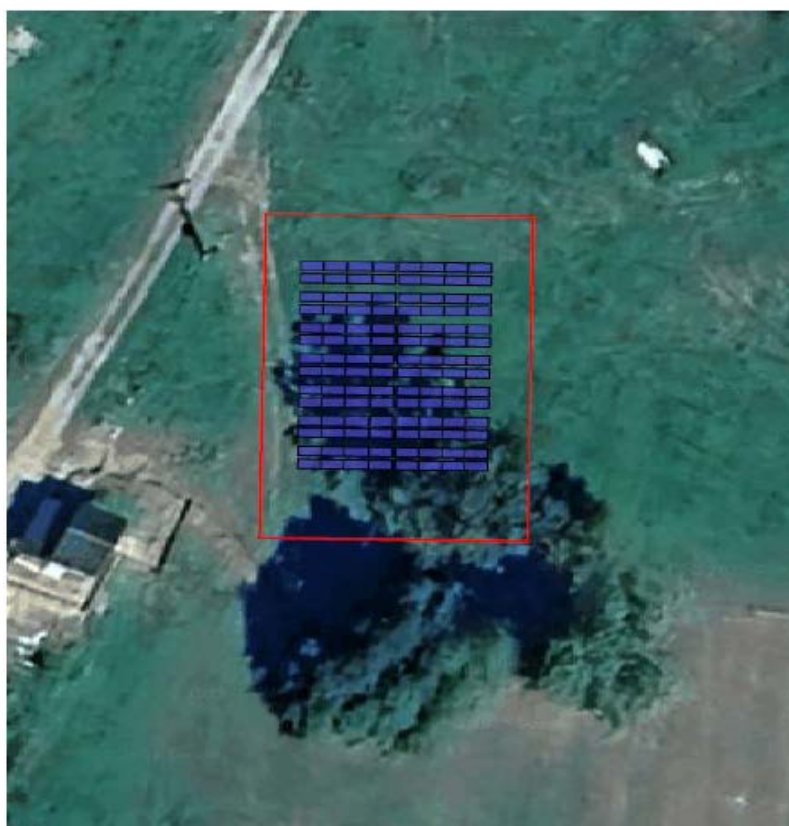
Slika 9. Prikaz položaja fotonaponskog polja s razmještajem fotonaponskih modula sunčane elektrane Privreda Pecki II (Izvor: Staticpro d.o.o., 2025.)
