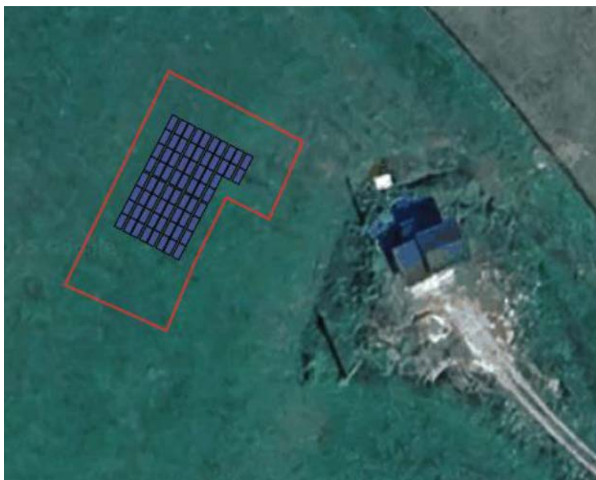
Slika 11. Prikaz položaja fotonaponskog polja s razmještajem fotonaponskih modula sunčane elektrane Pecki XI (Izvor: Staticpro d.o.o., 2025.)
