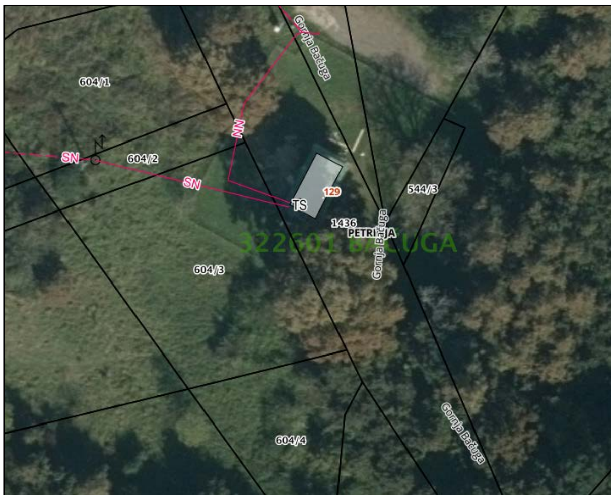
Slika 2. Prikaz postojećeg stanja elektroenergetske infrastrukture (elektroenergetski vod srednjeg i niskog napona i transformatorska stanica) na području planirane sunčane elektrane Privreda GB II na lokaciji Gornja Bačuga 129 (Izvor: Sustav katastra infrastrukture, Državna geodetska uprava)
