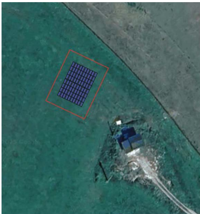
Slika 10. Prikaz položaja fotonaponskog polja s razmještajem fotonaponskih modula sunčane elektrane Pecki X (Izvor: Staticpro d.o.o., 2025.)
