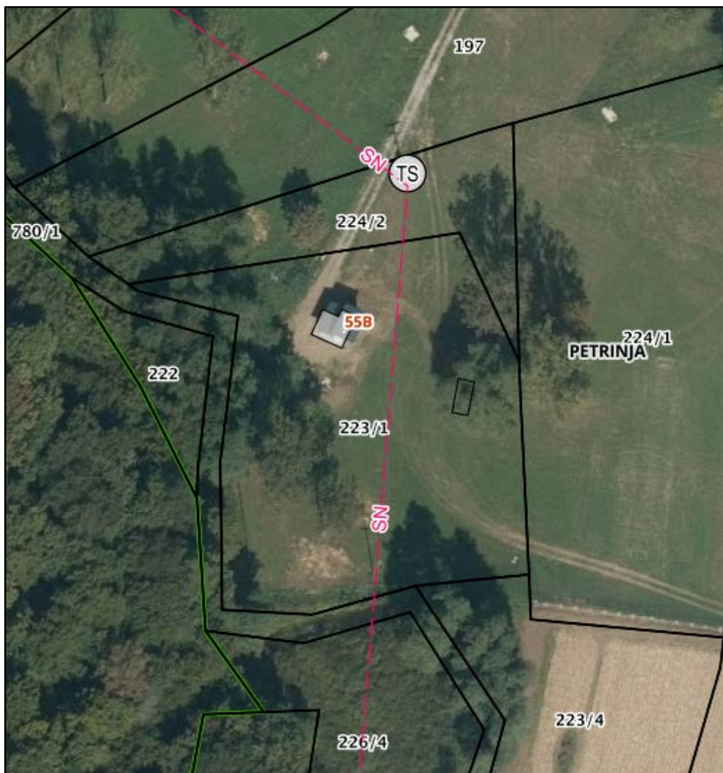
Slika 3. Prikaz postojećeg stanja elektroenergetske infrastrukture (elektroenergetski vod srednjeg napona i transformatorska stanica) na području planirane sunčane elektrane Privreda Pecki II na lokaciji Pecki 55B (Izvor: Sustav katastra infrastrukture, Državna geodetska uprava)
