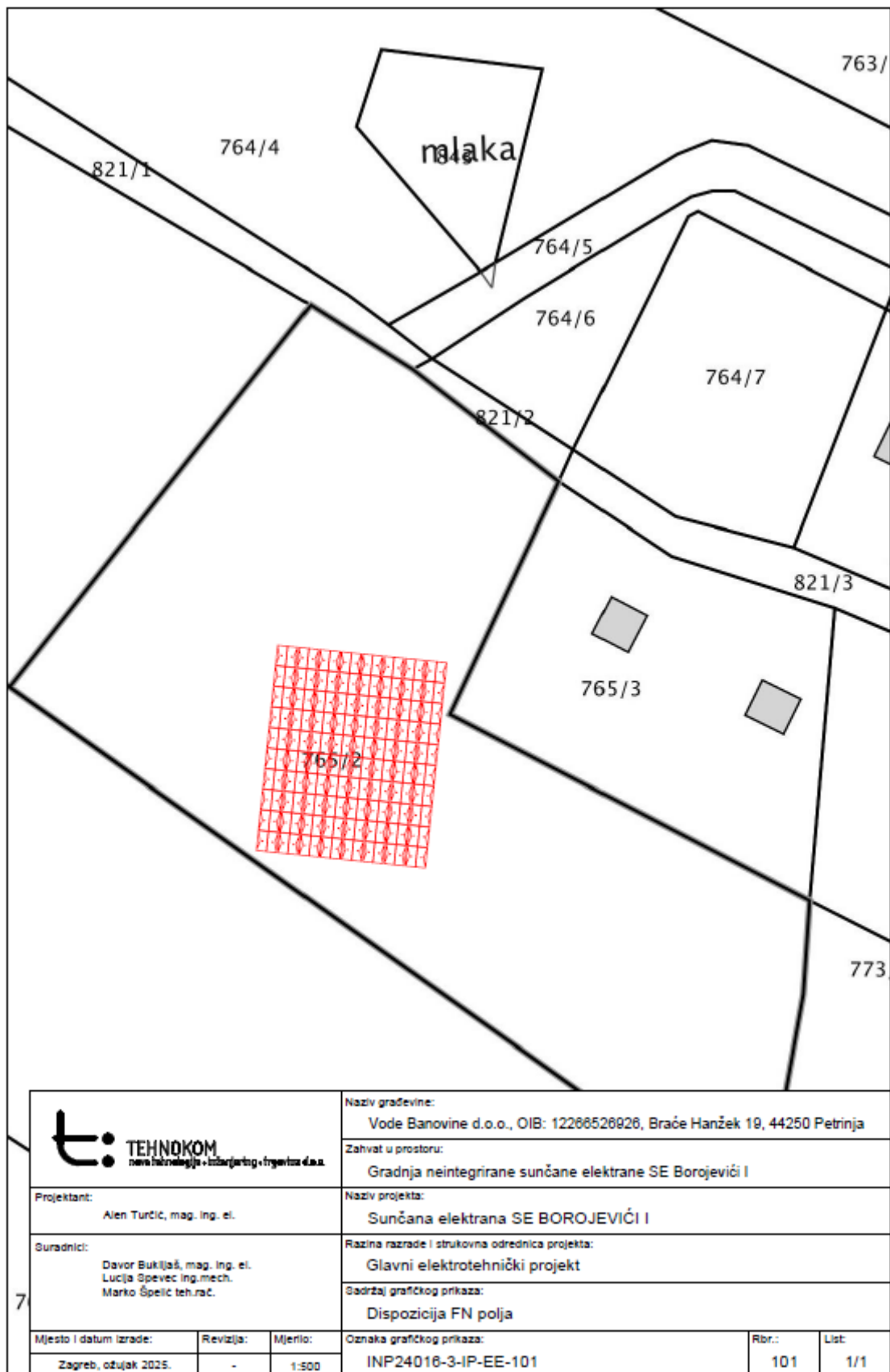
Slika 3. Prikaz sunčane elektrane s fotonaponskim poljem na lokaciji zahvata (Izvor: Tehnokom d.o.o., ožujak 2025.)
