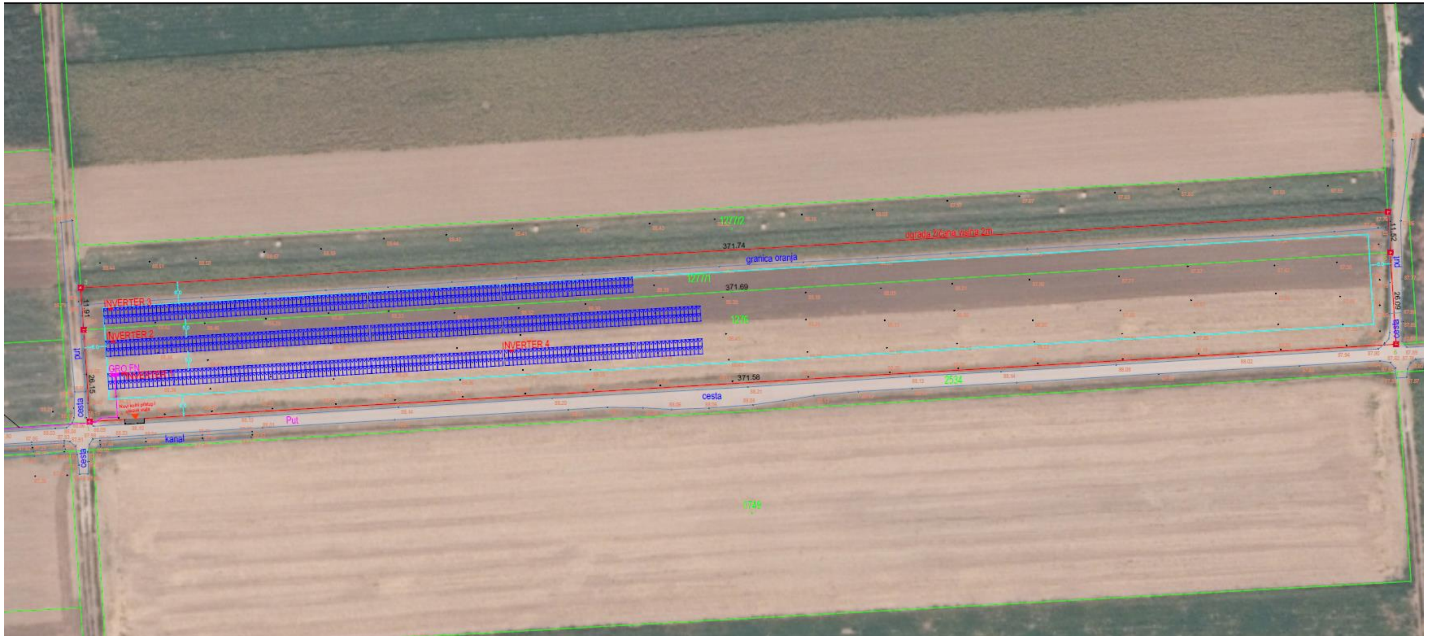
Slika 5. Situacija i dispozicija FN modula (1. dio) (Izvor: „IDEJNO RJEŠENJE SUNČANA ELEKTRANA BODIRKOVIĆ (M-Team d.o.o., 105/24MT, Čepin, travanj 2024.)
