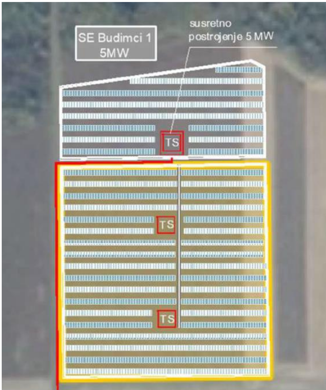
Slika 3. Dispozicija FN modula (Izvor: idejni projekt „Neintegrirana sunčana elektrana Budimci 1, električne snage 5 MW“ (AB energija d.o.o., Jelisavac, ožujak 2024.))
