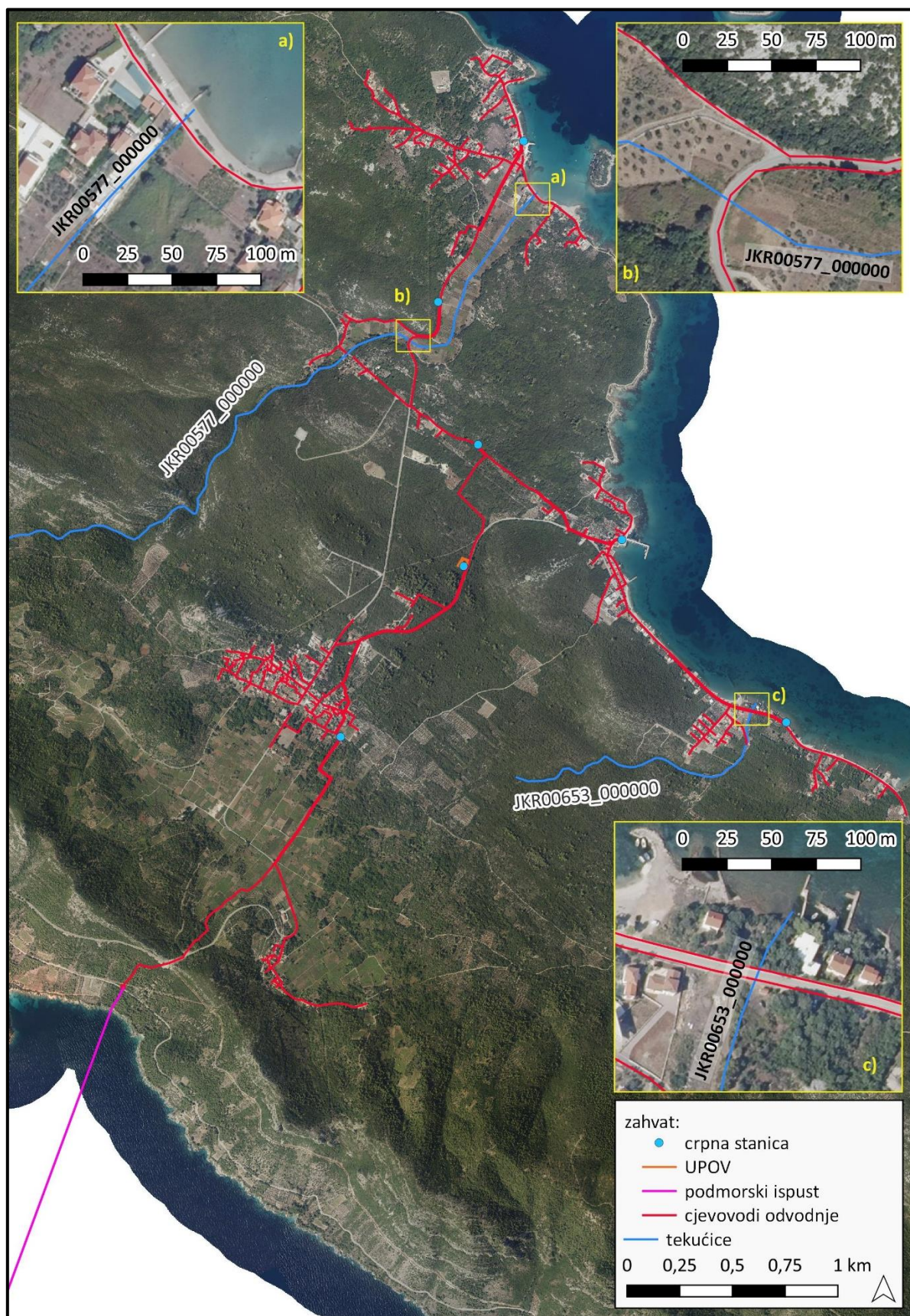
Slika 3.1.5-4. Površinska vodna tijela – tekućice na području zahvata s uvećanim lokacijama križanja vodnih tijela s trasama predviđenih cjevovoda (izvor: Hrvatske vode, 2023.)
