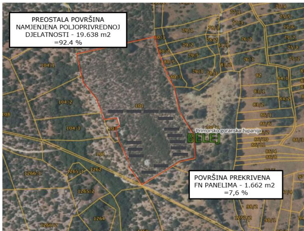
Slika 2. Postotni prikaz zauzetosti čestica sa sunčanom i poljoprivrednom djelatnosti (Izvor: „Tehnički opis planiranog proizvodnog postrojenja uz utvrđivanje posebnih uvjeta i uvjeta priključenja Agrosunčana elektrana (ASE Belejski) – 300 kW za proizvodnju električne energije“ (ELKIN Inženjering, Rijeka, lipanj 2024.)
