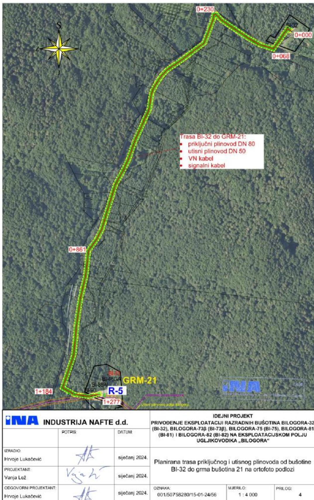
**Slika 8.** Ortofoto prikaz planirane trase priključnog i utisnog plinovoda od bušotine BI-32 do grma bušotina 21 s prikazom katastarskih čestica i obuhvatom zahvata (M 1:4 000) s instalacijama
