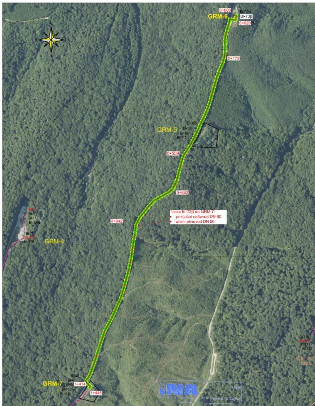
**Slika 14.** Ortofoto prikaz planirane trase priključnog i utisnog plinovoda od bušotine BI-73β do grma bušotina 7 s prikazom katastarskih čestica i obuhvatom zahvata (M 1:4 000)
