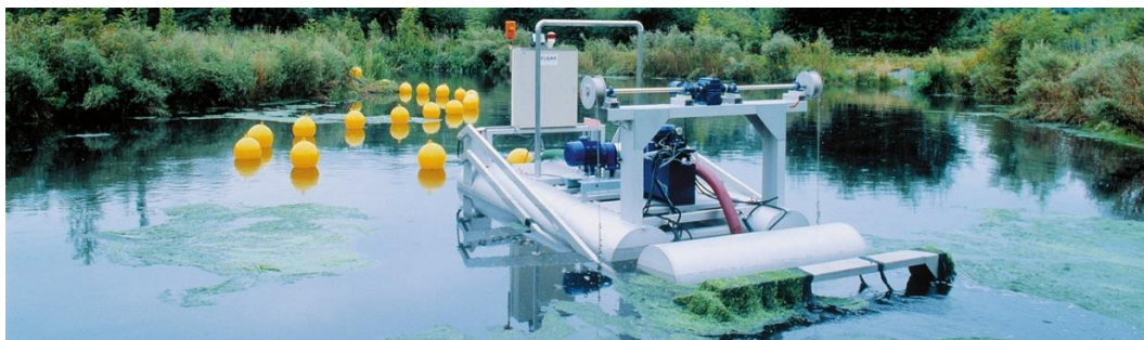
Slika 2.4-11. Primjer uporabe refulera na čišćenju dna jezera (Studija izvedivosti, Oikon 2024)
