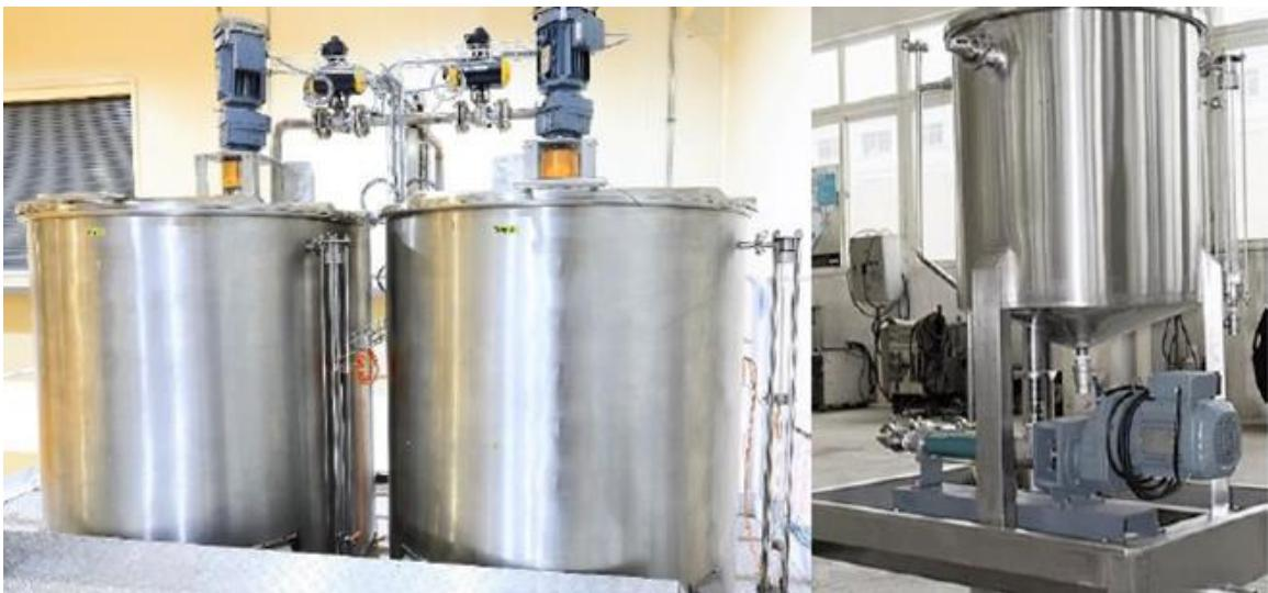
Slika 1.16 Spremniči za pripremu mikrokomponenata i doziranje vode
