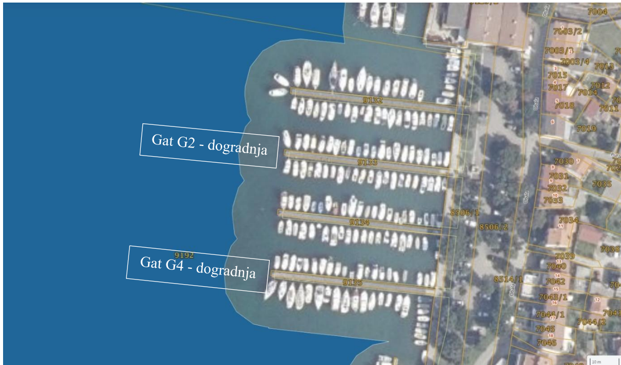
Slika 4. Postojeće stanje sjevernog dijela lučkog područja na kojem se planira dogradnja i rekonstrukcija gatova G2 i G4 (zahvat 1)
