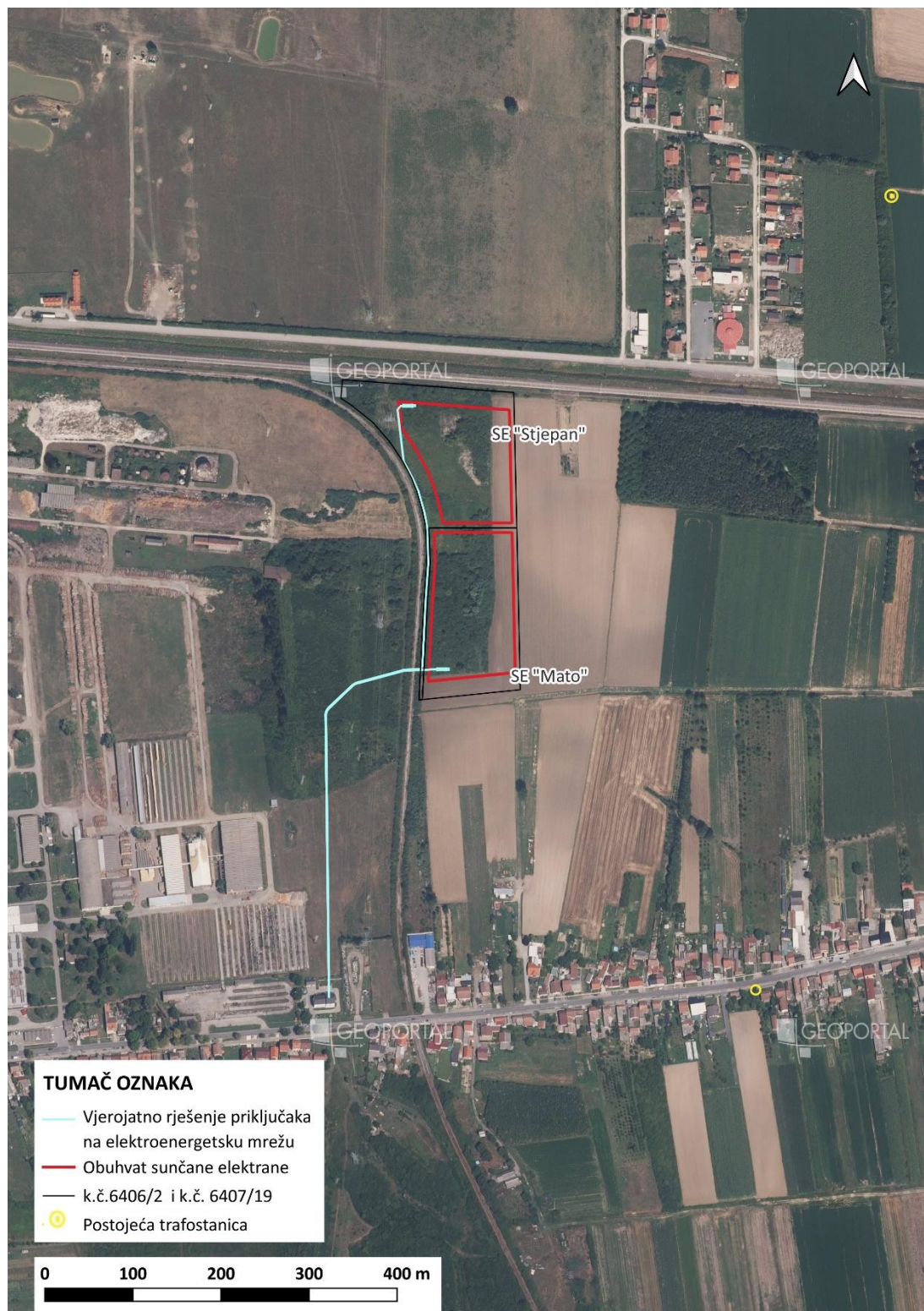
Grafički prikaz 3-6: Vjerojatno rješenje priključaka na elektroenergetsku mrežu Izvor: Idejni projekt SE Stjepan, Idejni projekt SE Mato, WMS DGU DOF
