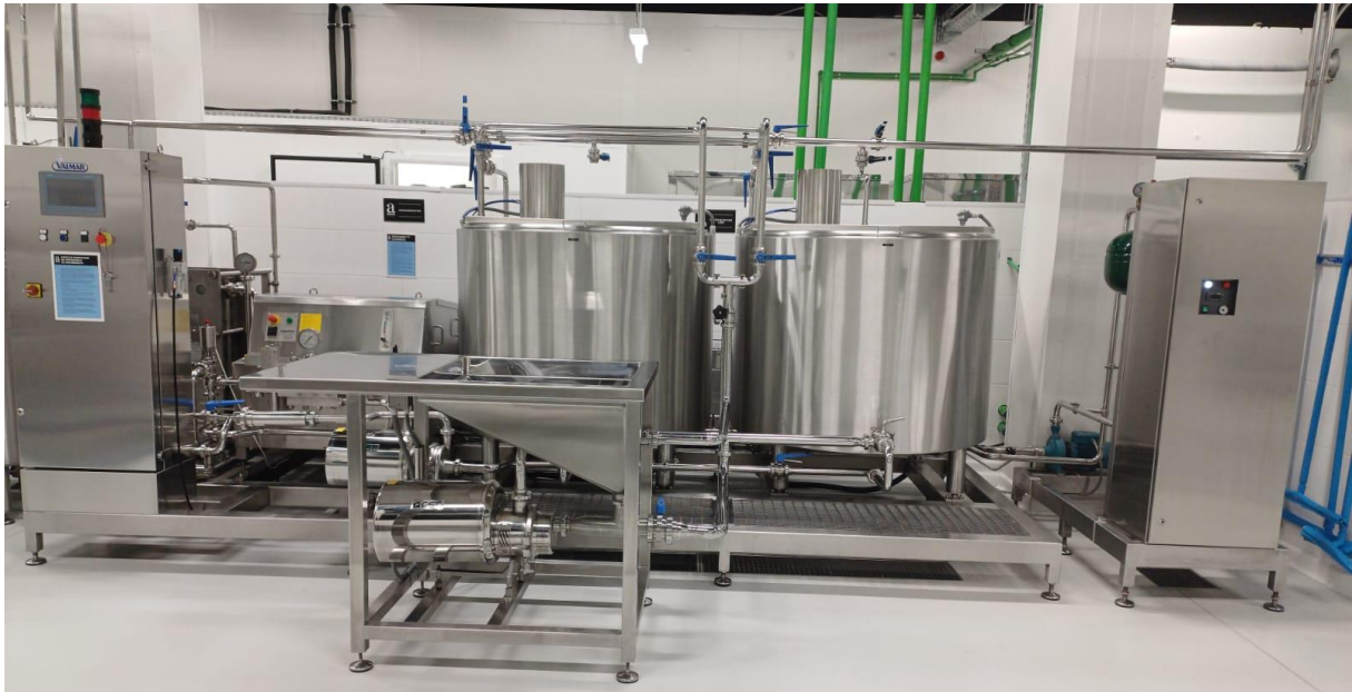
Slika 7. Pasterizator kapaciteta 1200 lit
