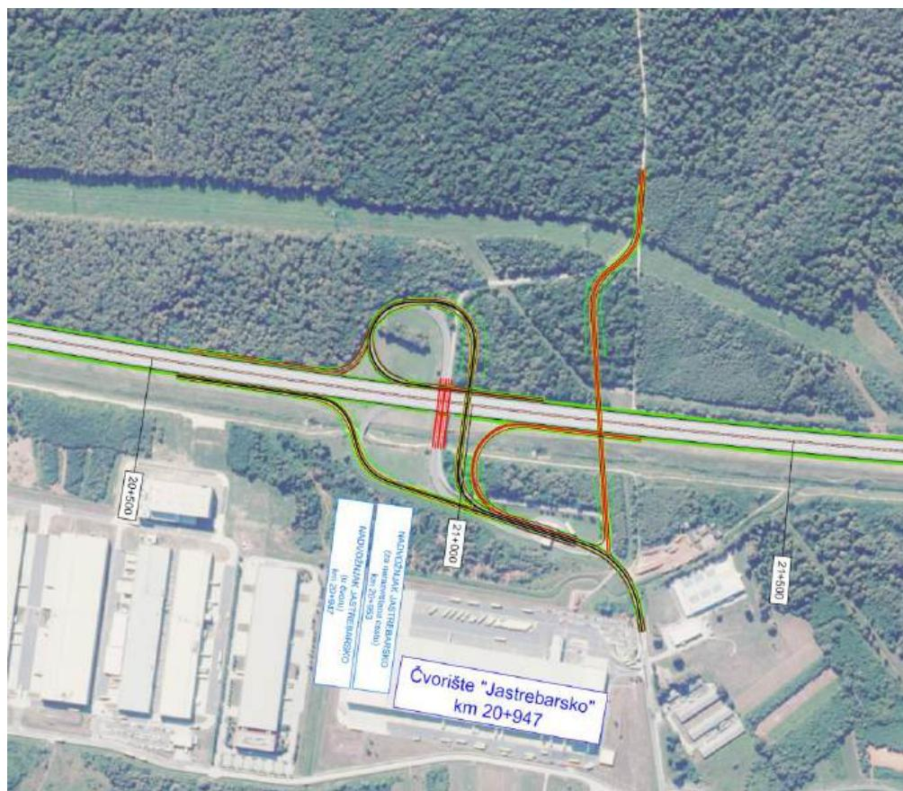
Slika 2.2.4.4. Čvorište Jastrebarsko-rekonstrukcija postojećeg čvorišta
