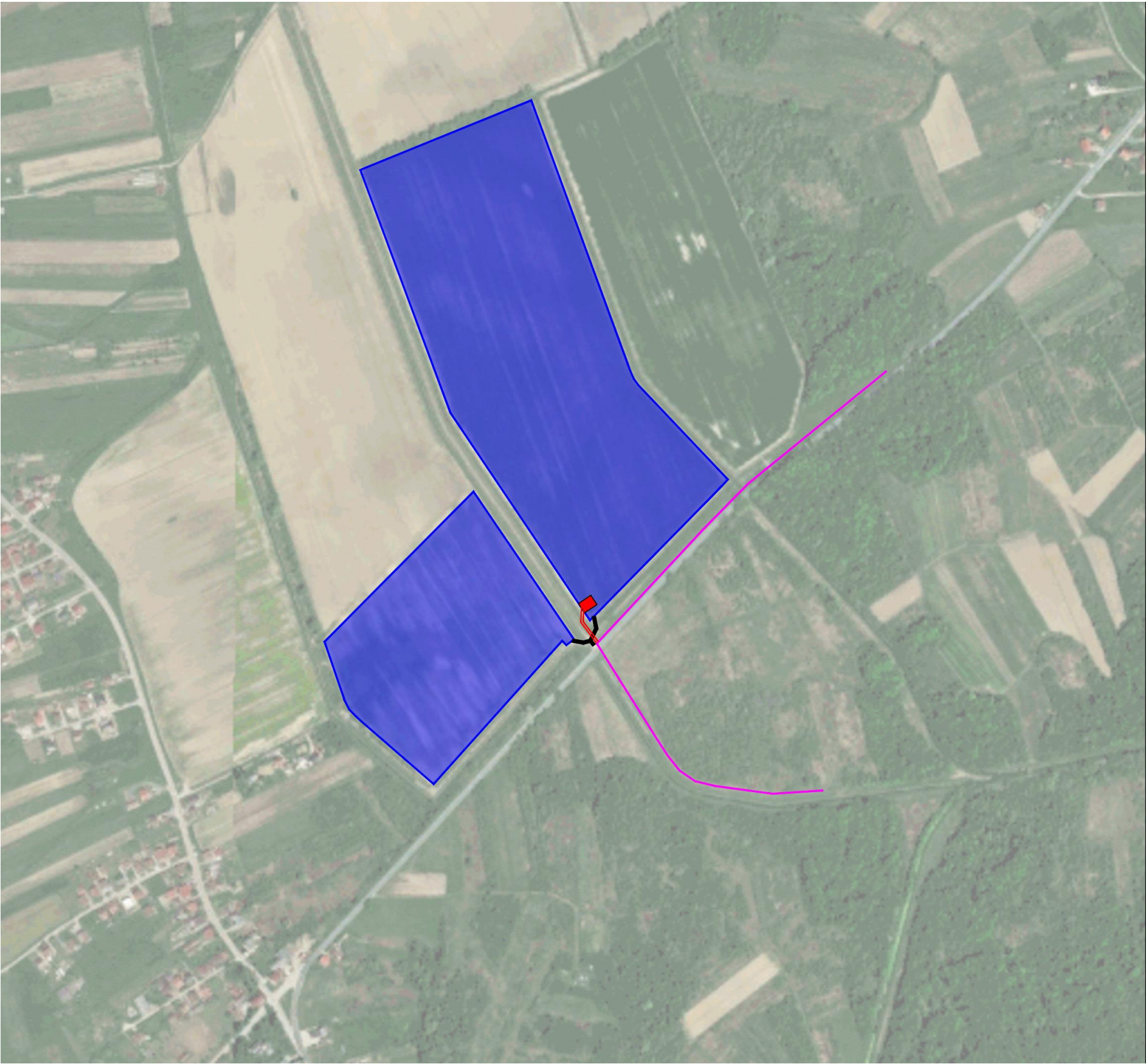
Slika 6. Situacija SE BRCKOVLJANI – opcija 1 priključka na mrežu; Izvor: Idejno rješenje SUNČANA ELEKTRANA BRCKOVLJANI, Izrađivač: Fractal d.o.o., Split, prosinac 2023.
