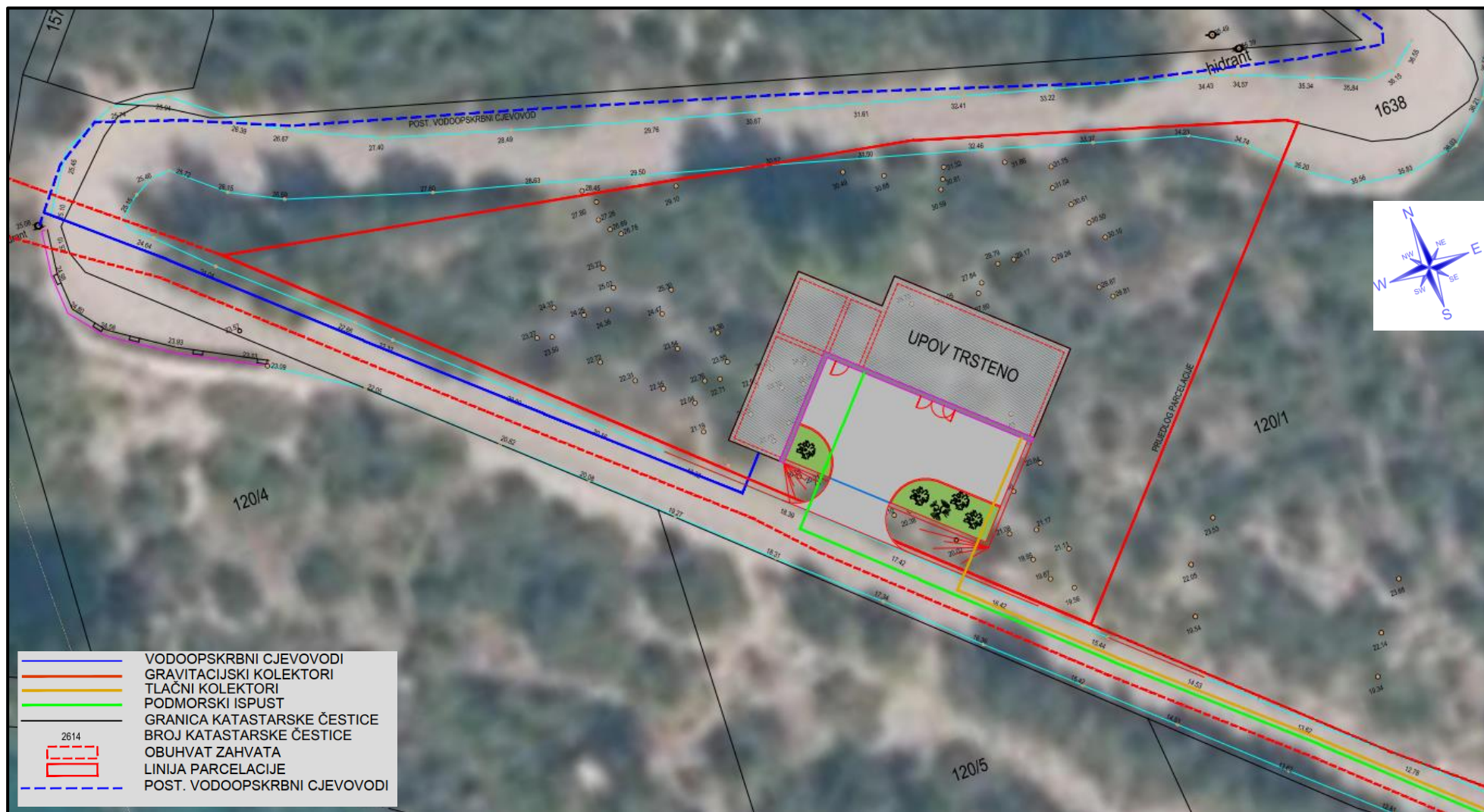
Slika 2.2-3. Situacijski prikaz UPOV-a Trsteno (izvor: Hidroprojekt-ing d.o.o., 2021.)
