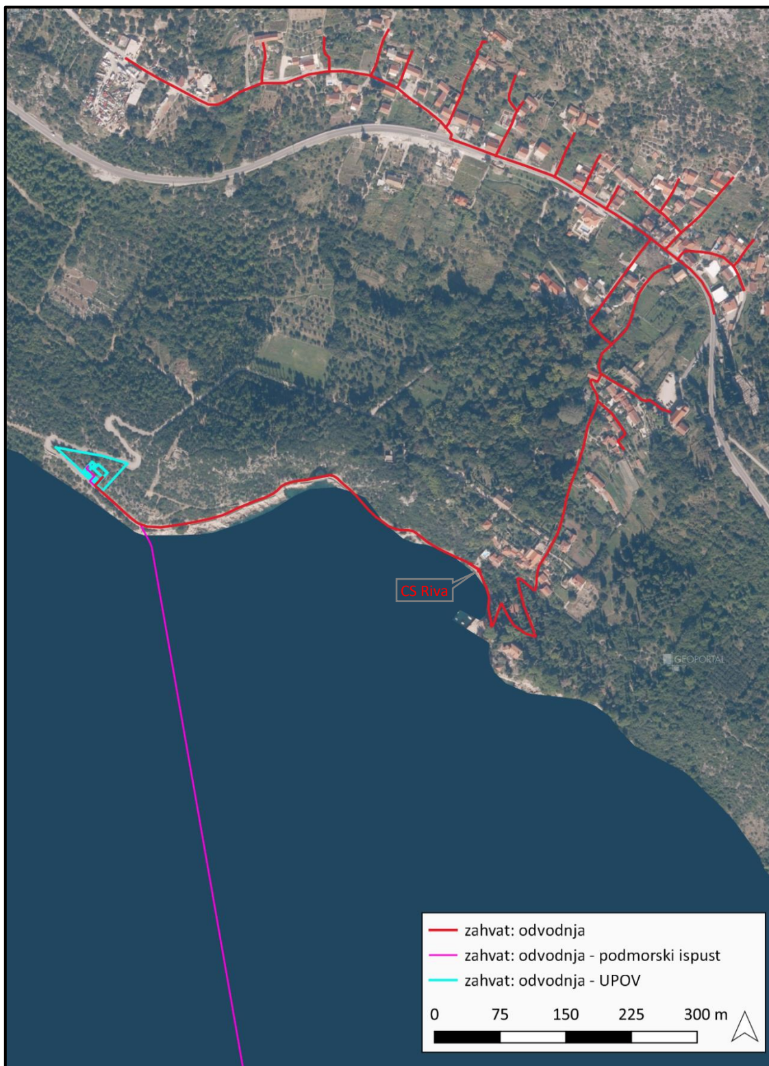
Slika 2.2-2. Situacijski prikaz zahvata odvodnje i pročišćavanja otpadnih voda te podmorskog ispusta Tršteno na ortofoto podlozi ( podloga: Geoportal, 2022. )
