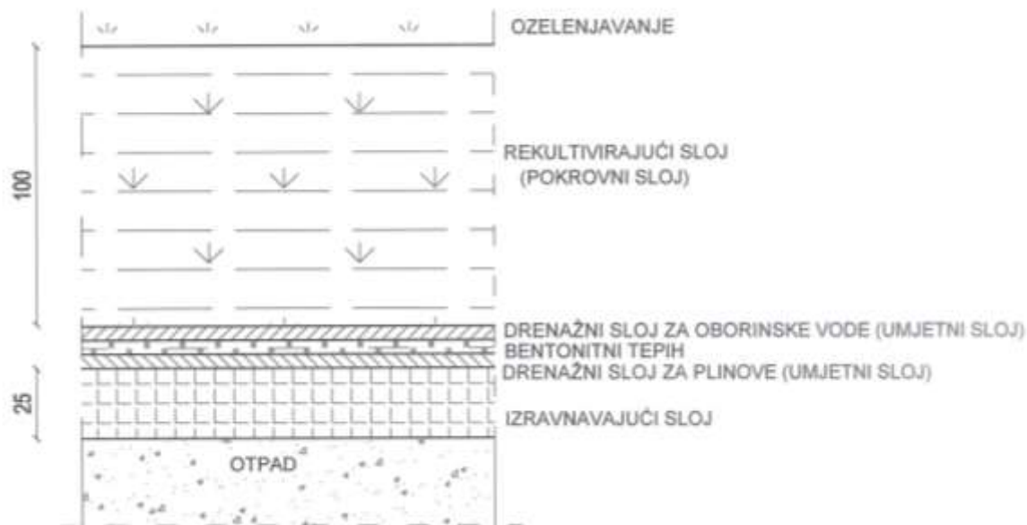
Slika 2.2/2 – Detalj završnog pokrovnog sloja
