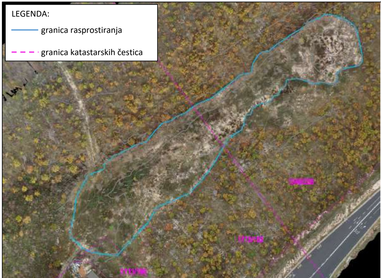
Slika 2.2.1.1.-1. Granica rasprostiranja iskopnog materijala prema geodetskoj snimci terena
