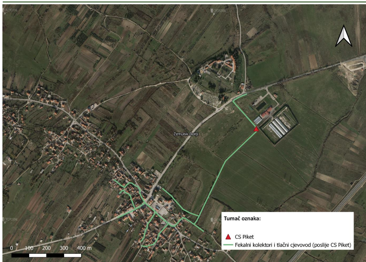
Grafički prikaz B-3: Položaj glavnih kolektora „Centar“ na području Općine Zemunik Donji
