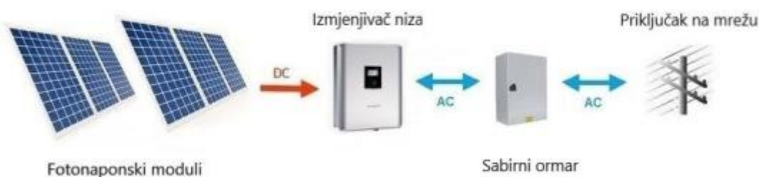
Slika 7. Principijelni prikaz fotonaponskog sustava s priključkom na NN mrežu
