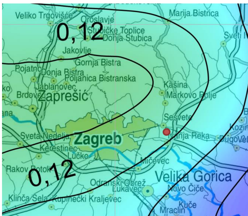
Slika 18. Vršna ubrzanja tla uzrokovana potresima za područje lokacije zahvata za povratni period 95 godina.
