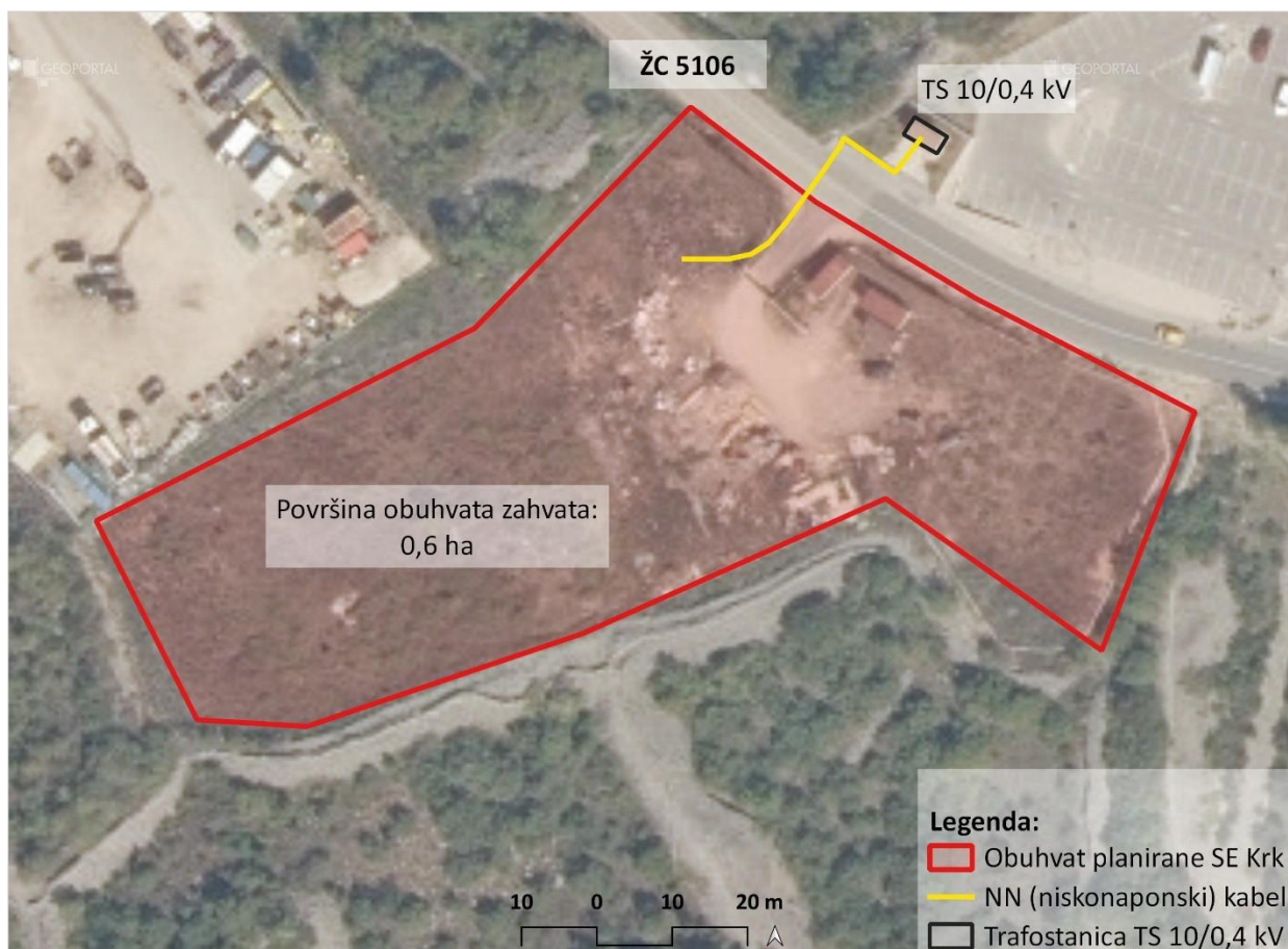
Slika 2. Prikaz obuhvata zahvata, nn kabela i trafostanice
