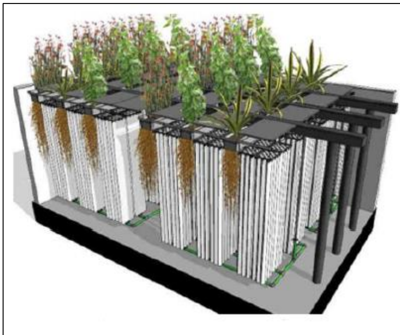
Slika 3. Prikaz ugradnja modula u biološkom bazenu
