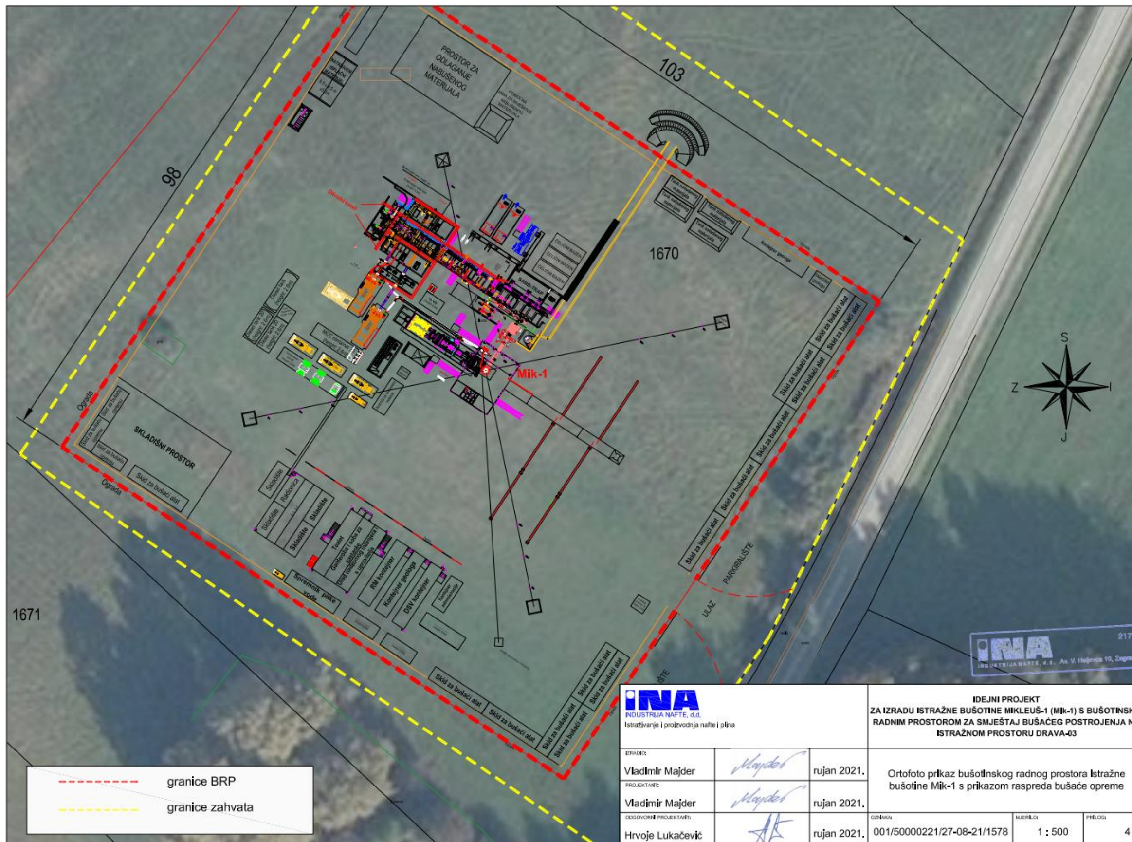
Slika 1. Raspored opreme na bušotinskom radnom prostoru bušotine Mikleuš-1 (Izvor: Idejni projekt)
