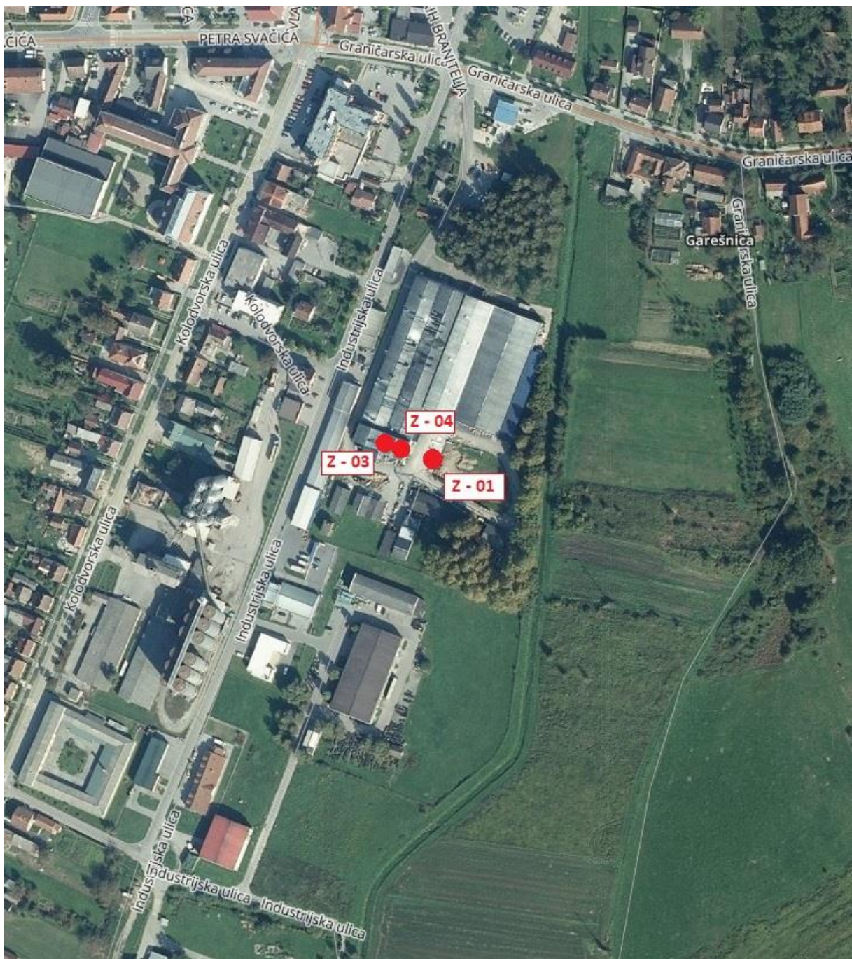
Slika 31 Prikaz ispusta RTO postrojenja (Z-01) i kotlovnice (Z-03, Z-04) Izradio: Interkonzalting d.o.o.
