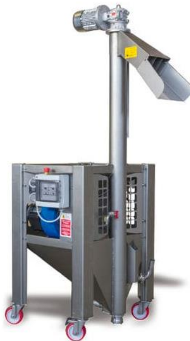
Slika 10. „ Baby Dle “ stroj za odstranjivanje listova, prljavih ostataka i pranje maslina
