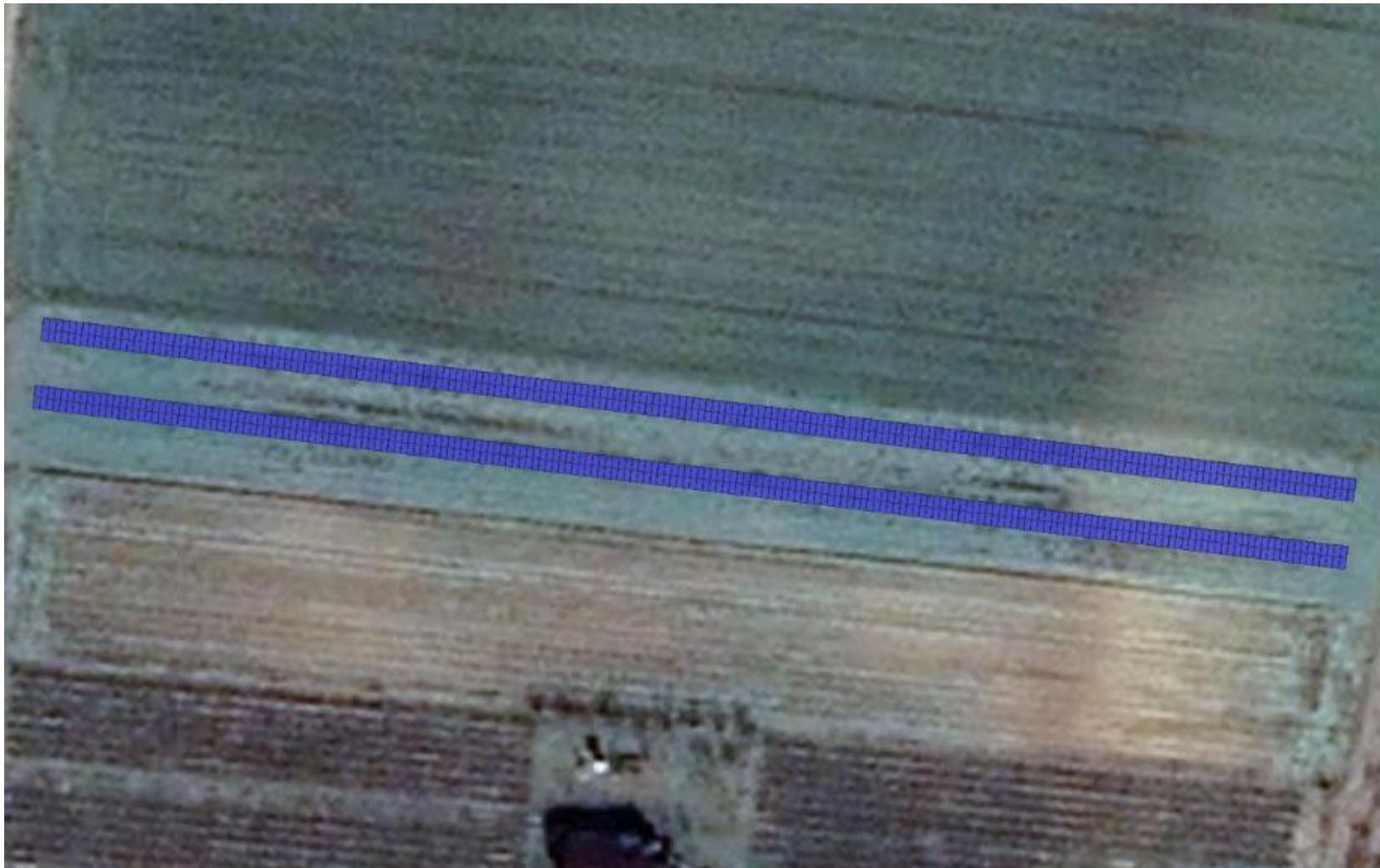
Slika 7. Pregledna situacija zahvata s rasporedom fotonaponskih panela
