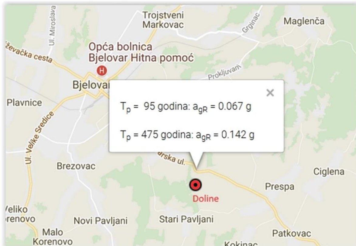
Slika 16. Vrijednost horizontalnih vršnih ubrzanja očekivanih na lokaciji s Karte potresnih područja Republike Hrvatske (PMF, Sveučilište u Zagrebu) s iznosima horizontalnih vršnih ubrzanja tla tipa A( a_{gR} ) za povratna razdoblja od T_p = 95 i 475 godina ( www.seizkarta.gfz.hr )
