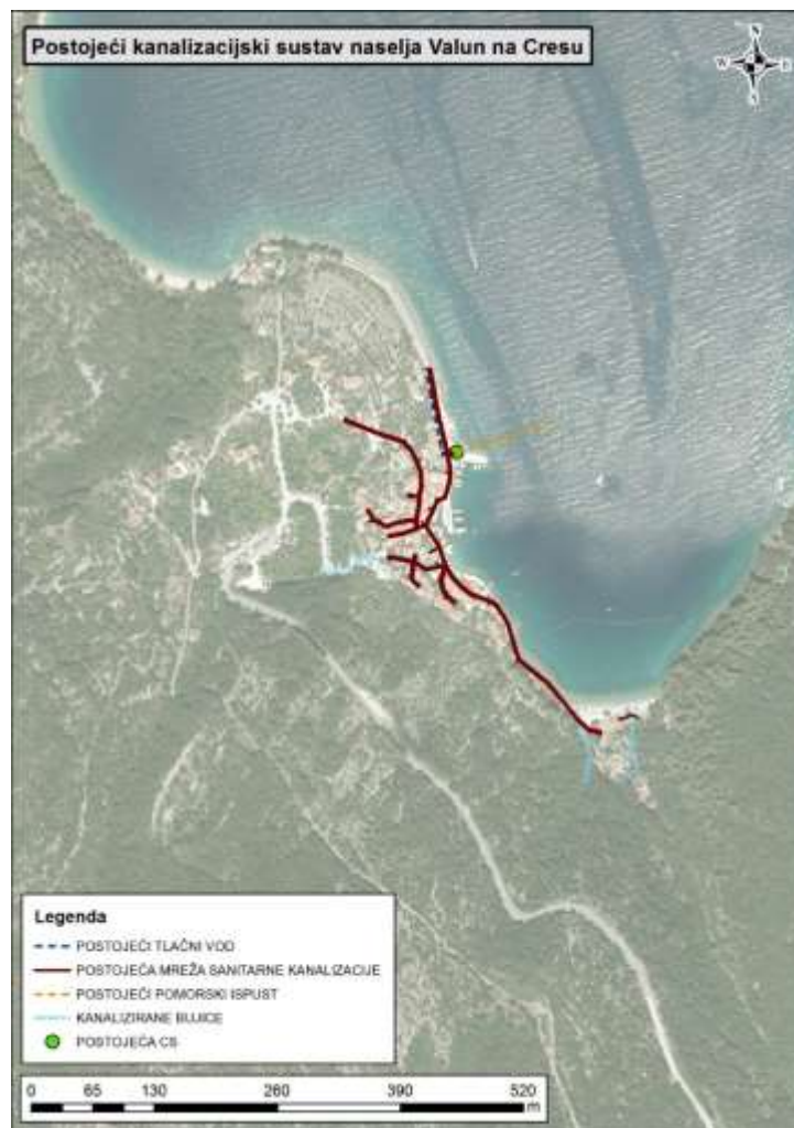
Slika 2.2 Sustav odvodnjeotpadnih voda - postojeće stanje
