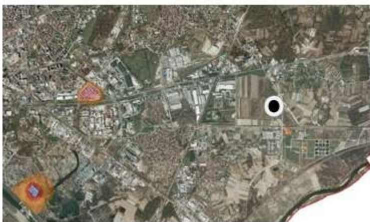
Slika 3.10/2 - Strateška karta buke industrijskih pogona i postrojenja-razredi jednakih razina buke indikatora L_{night} na užoj lokaciji planiranog zahvata (označena crnim krugom)
