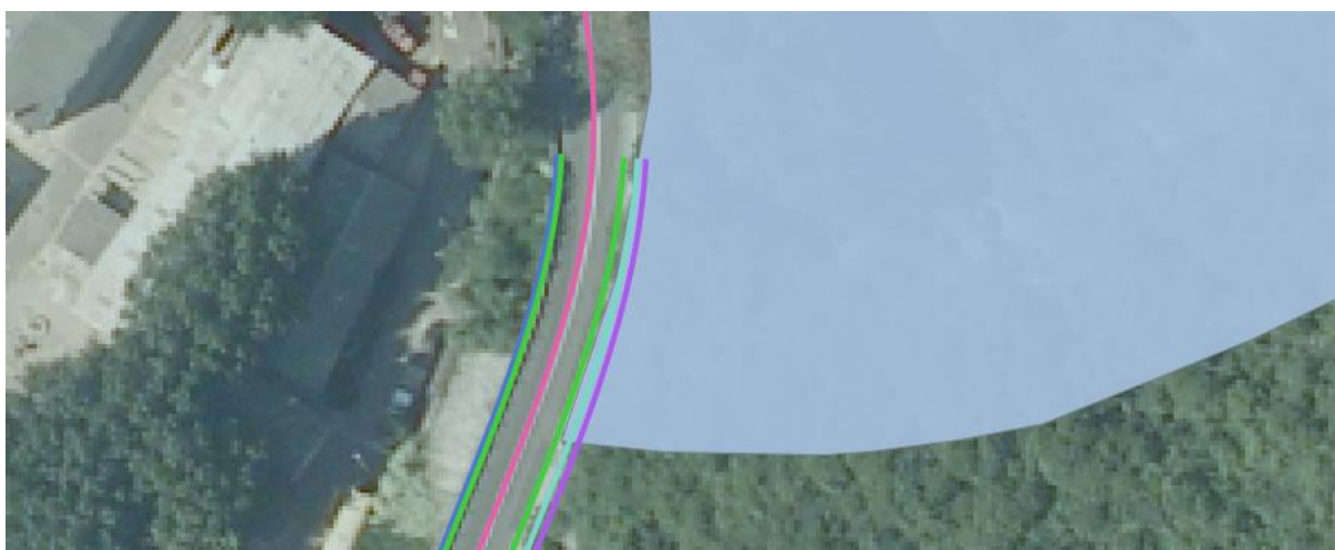
Slika 3.3.7.- 3. Detaljan prikaz zahvata na lokaciji koja graniči sa II zonom sanitarne zaštite izvorišta Martinščica (ljubičasto – usjek s zaštitnom mrežom, plavo – rub nogostupa); (izvor podataka: izvadak iz Registra zaštićenih područja od 02.03.2020.)
