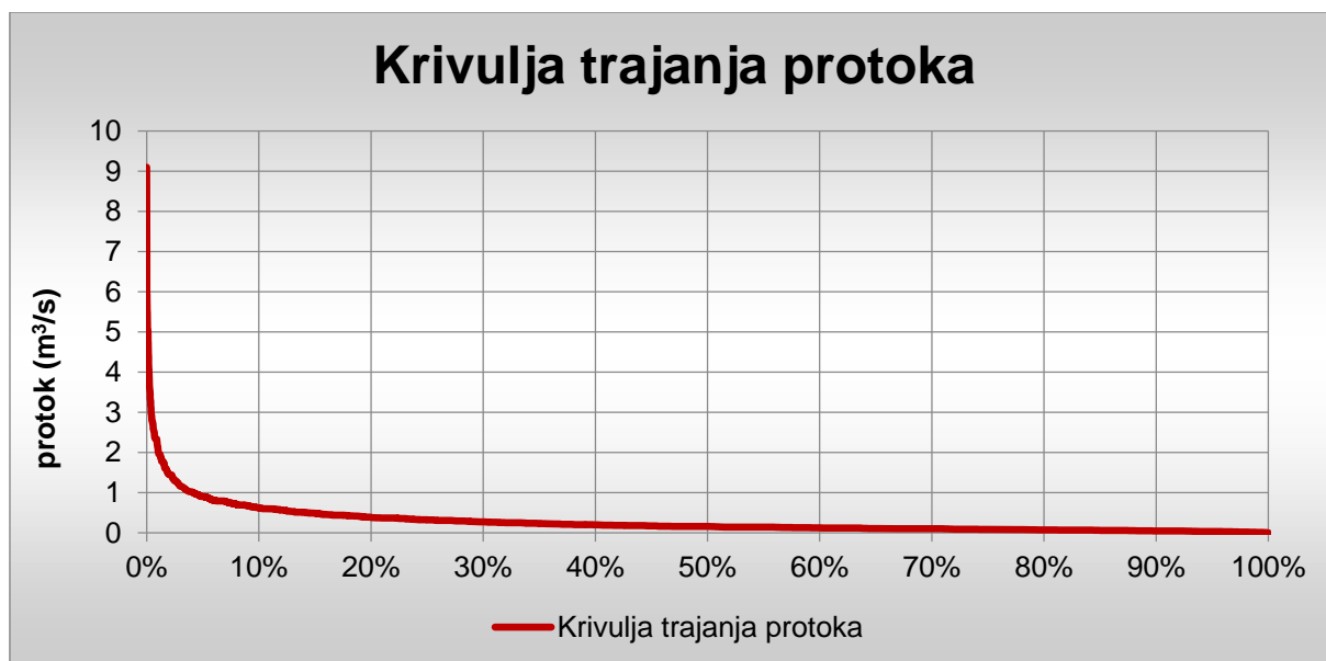
Slika 3.1.4-2. Krivulja trajanja protoka vodotoka Šumetlica prema podacima o izmjerenom protoku na postaji Cernik u razdoblju 1972-2013. i 2015-2017.
