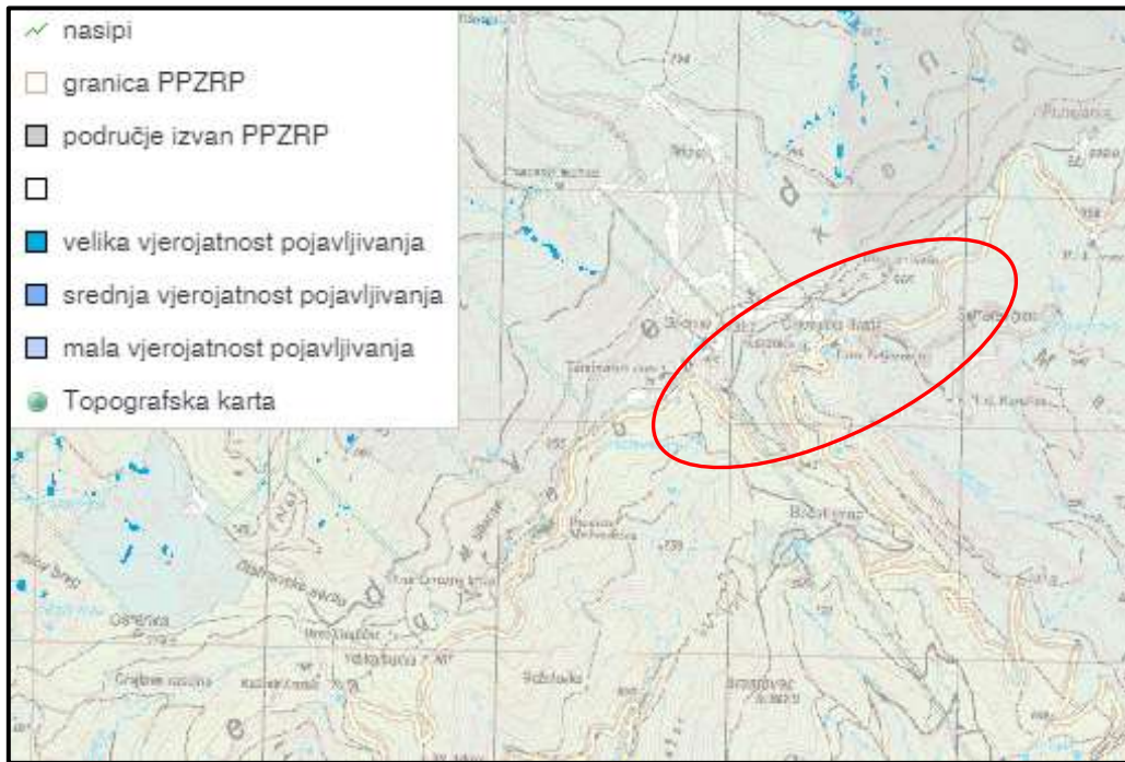
Slika 3.1.4-6. Karta opasnosti od poplava po vjerojatnosti pojavljivanja – šire područje zahvata s označenim područjem zahvata (izvor: Hrvatske vode, 2018.)
