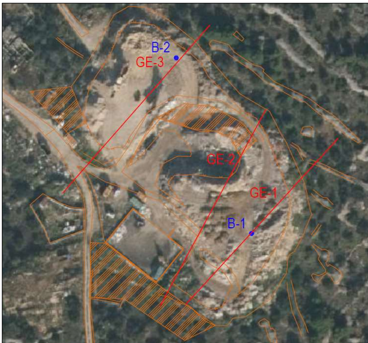
Slika 2.1.1.2.-1. Situacija istražnih radova sa profilima geoelektrične tomografije i pozicijama istražnih bušotina
