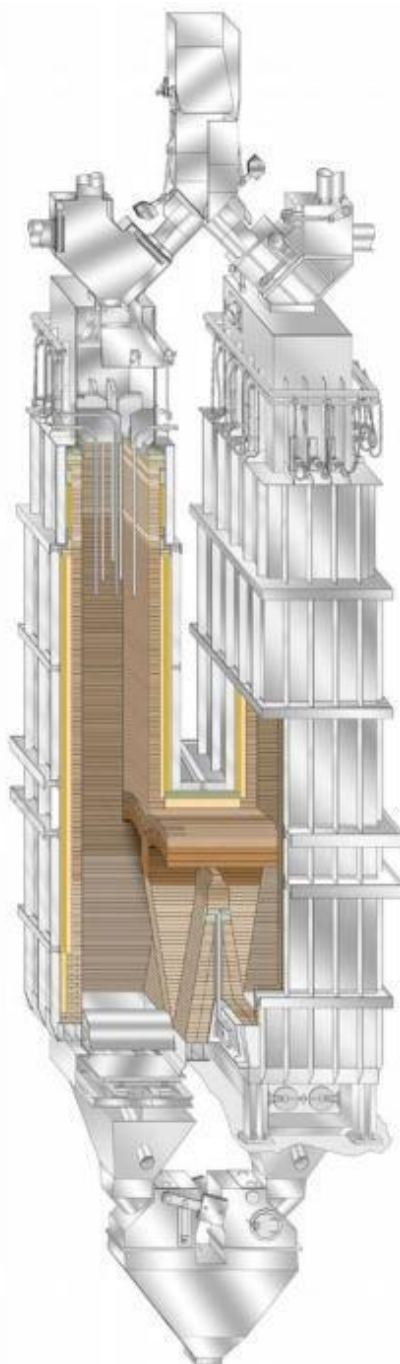
Sl. 2.1-3: Shematski prikaz Maerzove peći za vapno
