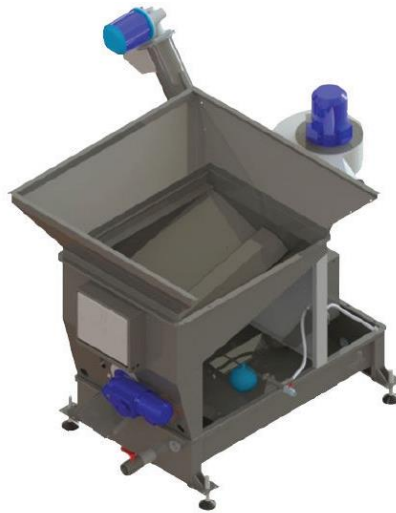
Slika 9. Stroj za odstranjivanje lišća i pranje maslina (Maxi DLE)
