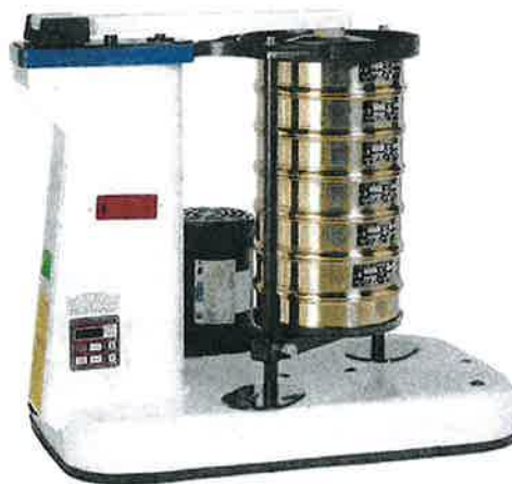
Slika 8. Mehanička tresilica za separaciju krupnozrnatih frakcija sedimenta.
