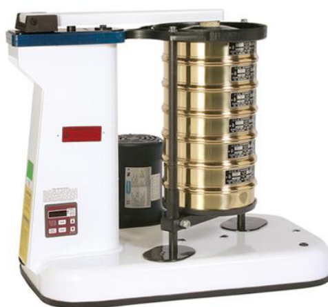
Slika 8. Mehanička tresilica za separaciju krupnozrnatih frakcija sedimenta.
