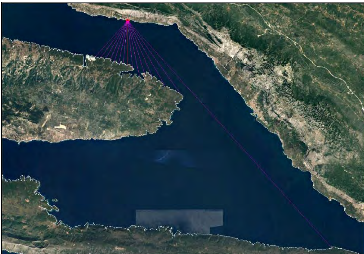
Slika 20. Prikaz centralne zrake kroz smjer S i zrake sa korakom \pm 6^\circ
