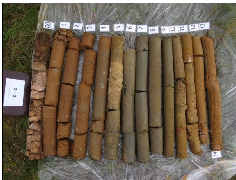
Slika 3.5.6: Jezgra dobivena iz bušotine O-2
