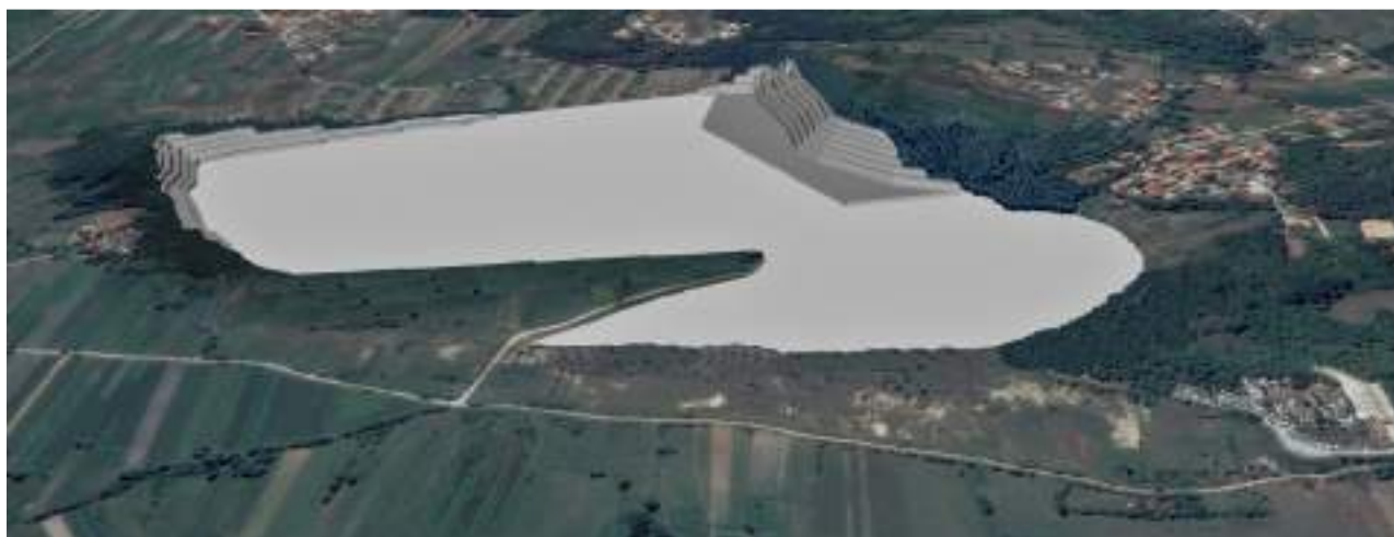
Slika 4.1./10. 3D model završnog stanja EP zajedno s eksploatacijskim poljem "Stipanovića greben-zapad"
