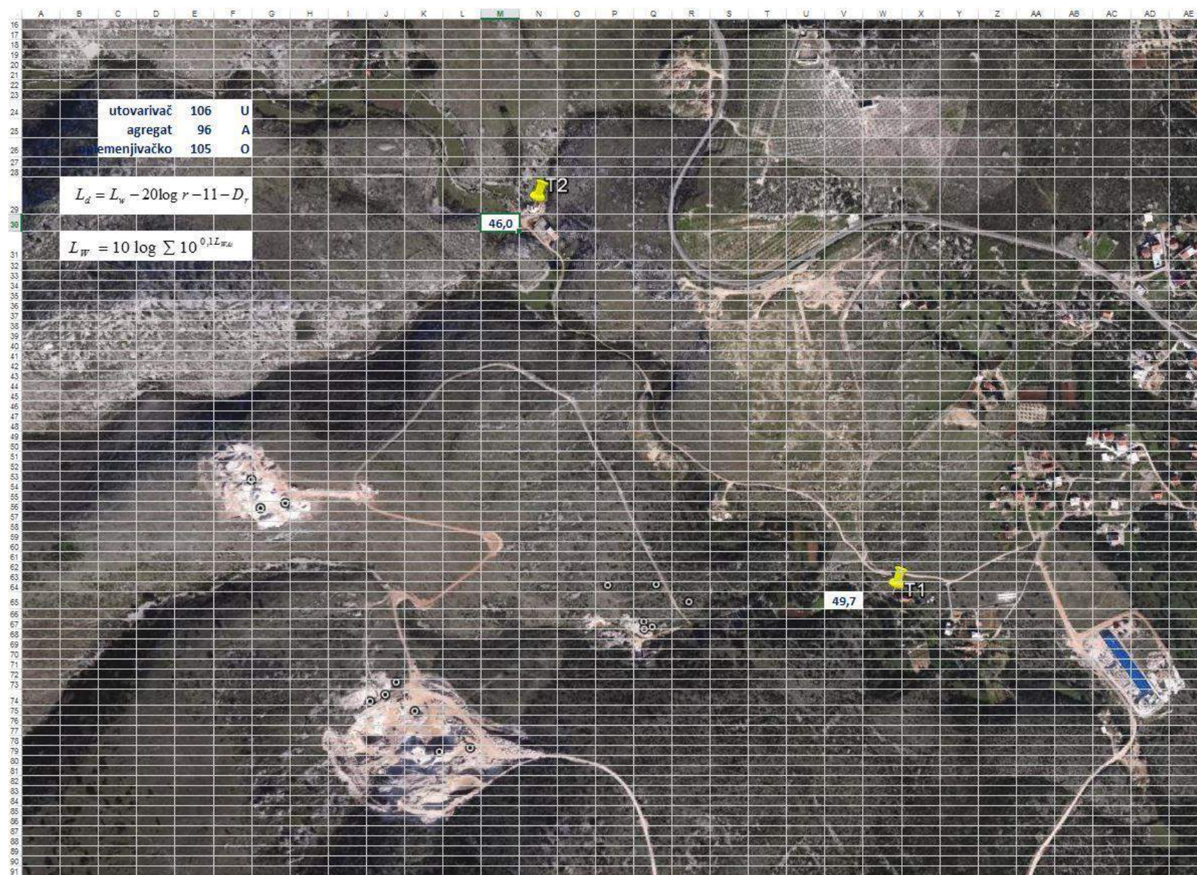
Slika 4./24. Izračunate razine buka na referentnim točkama prilikom rada svih izvora buke na svim eksploatacijskim poljima
