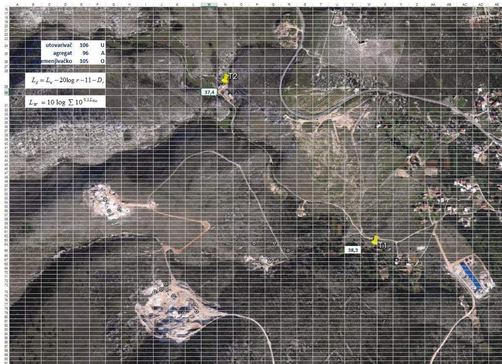
Slika 4./22. Izračunate vrijednosti uslijed rada izvora buke na EP Vedro
