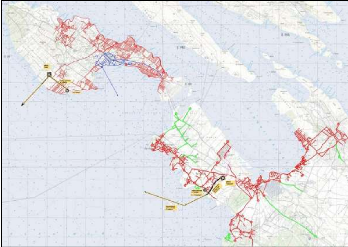
Slika 2.1-1. Varijanta A: 2 zasebna sustava odvodnje i pročišćavanja otpadnih voda
