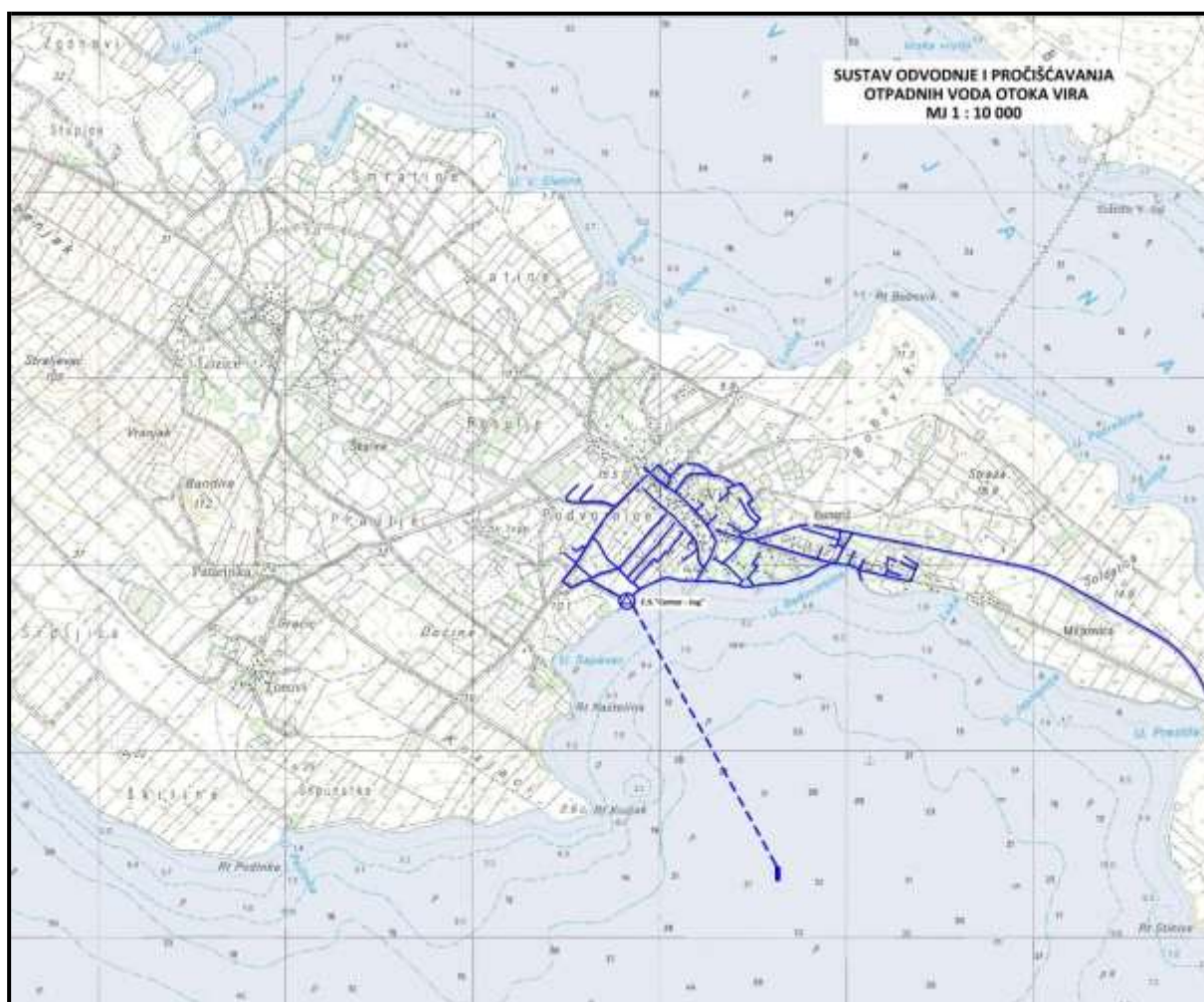
Slika 1.2.2-1. Izgrađeni dijelovi sustava odvodnje i pročišćavanja Vir
