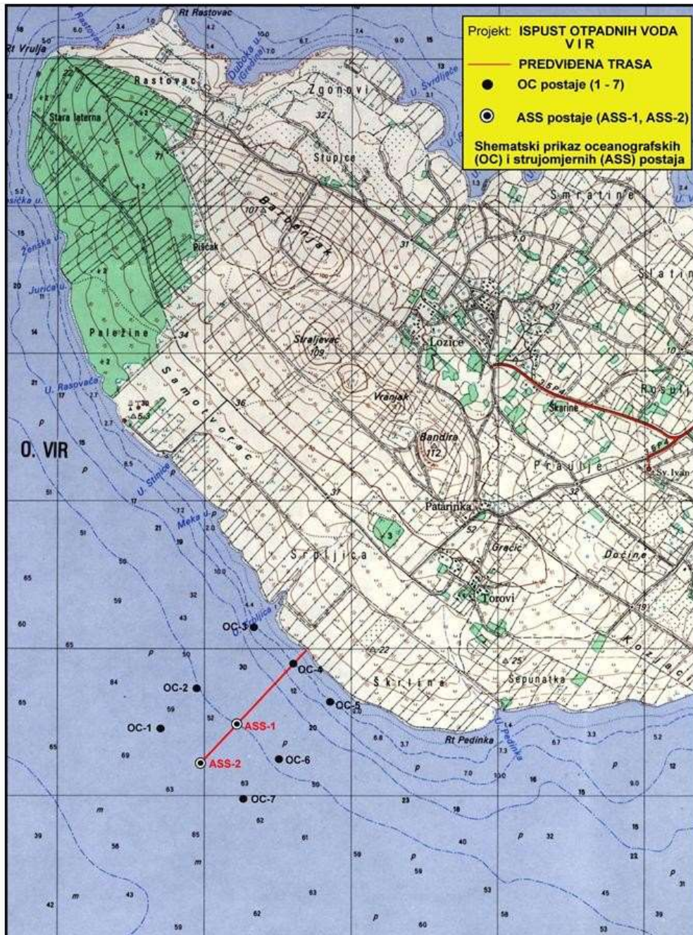
Slika 3.5-1. Shema oceanografskih (OC) i strujomjernih (ASS) postaja iz istraživanja provedenog 2004. godine (HHI)
