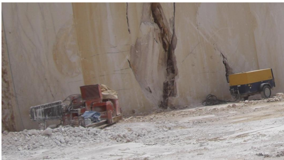
Slika 1.3./5. Lančana sjekačica i diesel agregat [32]
