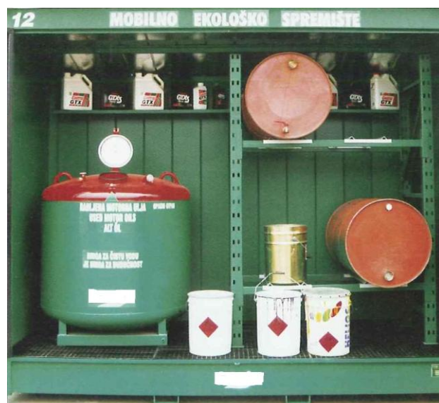
Slika 1.3./2. Mobilno priručno spremište ulja i maziva i otpadnog ulja
