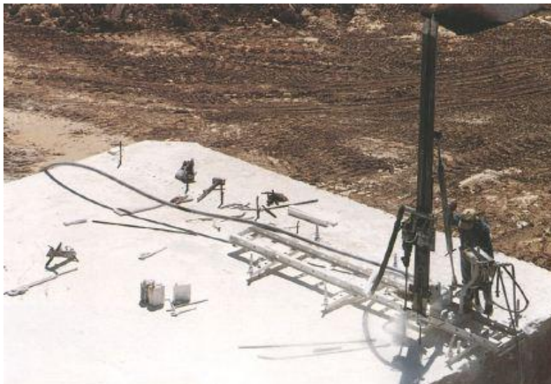
Slika 1.3./3. Bušača garnitura (sonda) [32]
