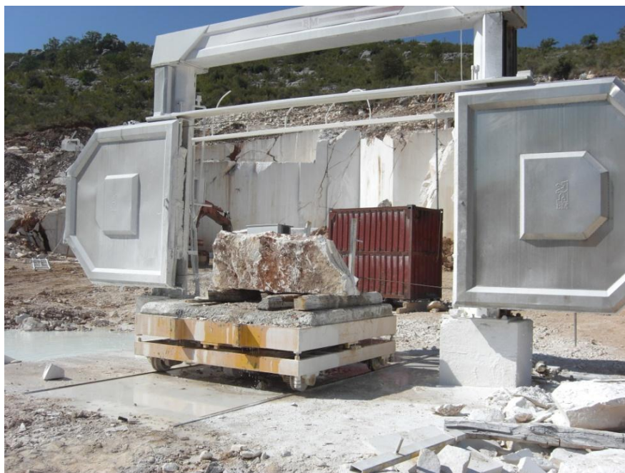
Slika 1.3./2. Dijamantni žični gater [32]
