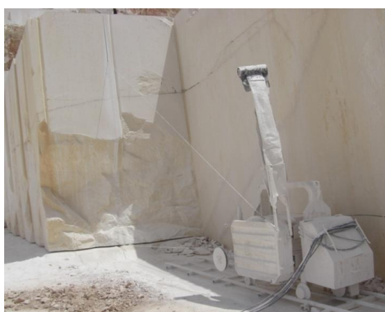
Slika 1.3./2. Dijamantni žični gater [32]
