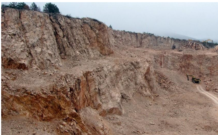
Formirane etaže na aktivnom eksploatacijskom polju
