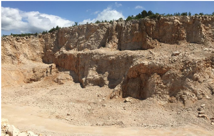
Formirane etaže na aktivnom eksploatacijskom polju
