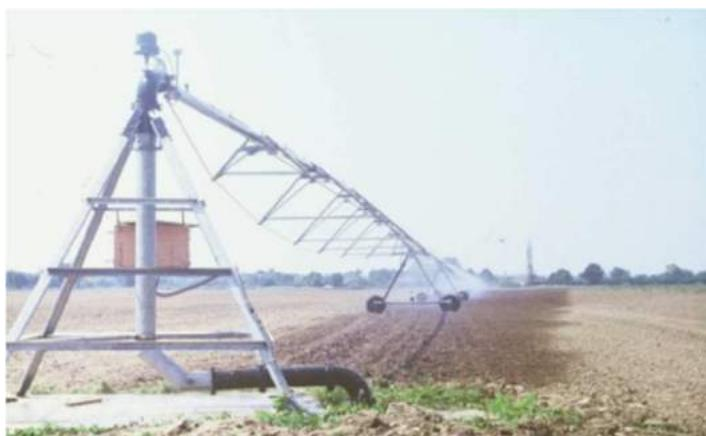
**Slika 26. Centralni dio „Pivot-sustava“ s kišnim krilom i priključkom na podzemne instalacije**
