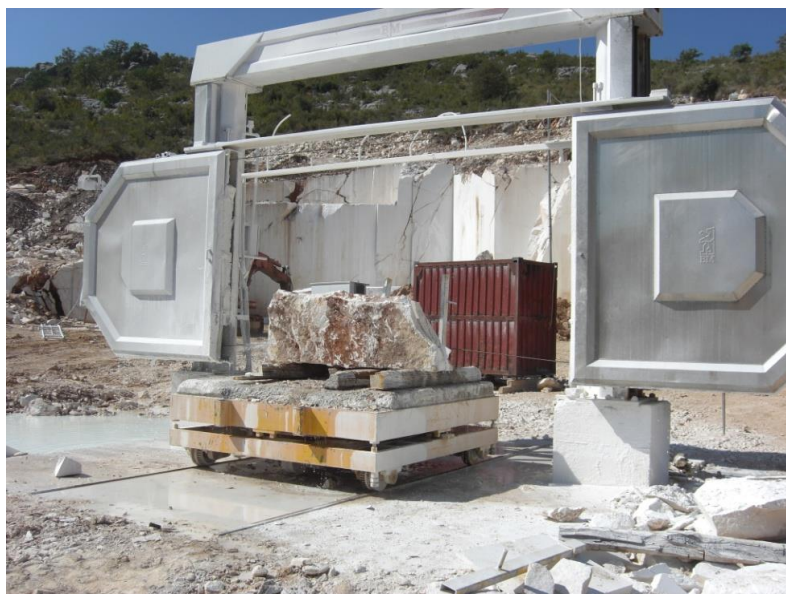
Slika 1.3./2. Dijamantni žični gater [39]
