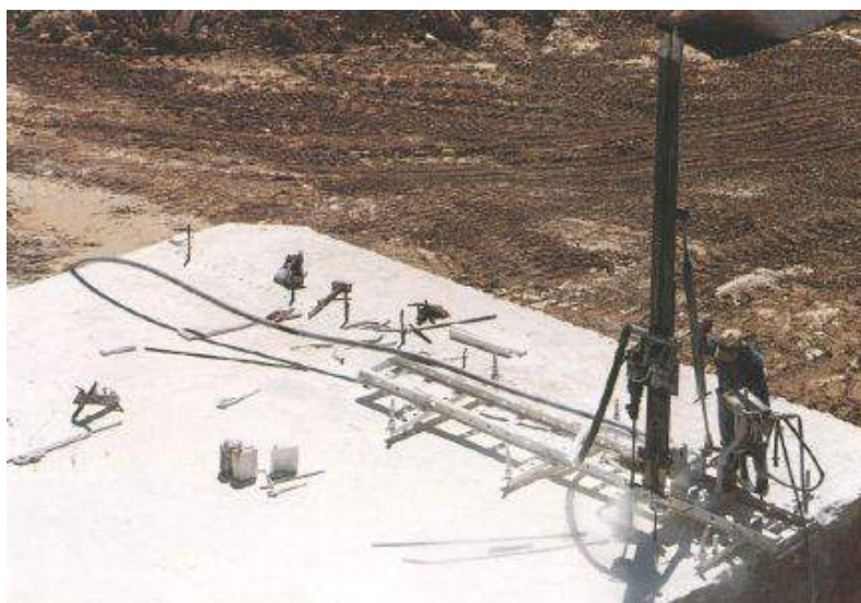
Slika 1.3./3. Bušača garnitura (sonda) [33]
