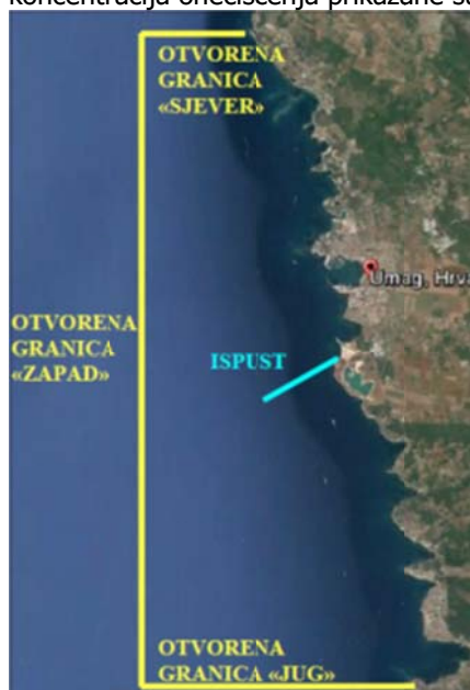
Slika 2.3 Prostorna domena numeričkog modela s otvorenim granicama (žuta boja) za provedbu numeričkih simulacija cirkulacije mora i pronosa onečišćenja
